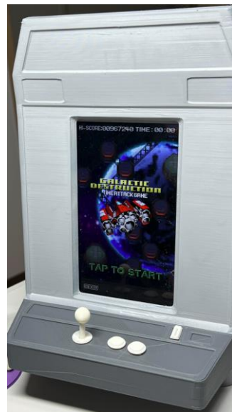
灰色部分はFDM機で出力 白色は光学機で出力
